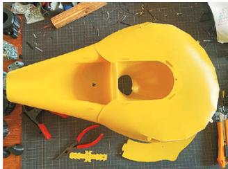
テングーさん設計のドライトイレ「コヤッシュ」。ポリプロピレンシートを切り抜き、手で折って組み立てる。
