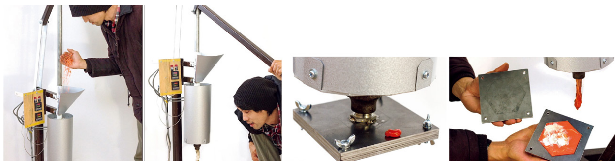
テンダーさん自作の射出成形機。破砕したプラごみを入れて溶かし、金型に流し込んで成形する。ダイナミックラボの金型には、アルミごみを溶かして固めた塊を削り出して作ったものもある。 画像提供:ダイナミックラボ
