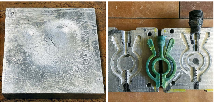
左|窓サッシと空き缶を熱で溶かして固めたアルミの塊 右|アルミの塊を削ってつくった洗濯バサミの金型。ここにプラスチックごみを破砕し、熱で溶かしたものを流し込んで洗濯バサミをつくる。 画像：ダイナミックラボ提供
