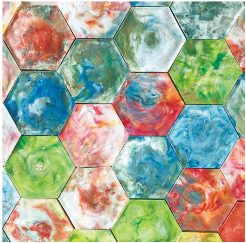
テンダーさんが自作の射出成形機と金型を使いプラごみから作ったタイル。
